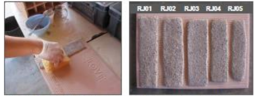
Figura 2. Aplicação das argamassas de substituição nos painéis experimentais. (Legenda: RJ: refecimento de juntas)
